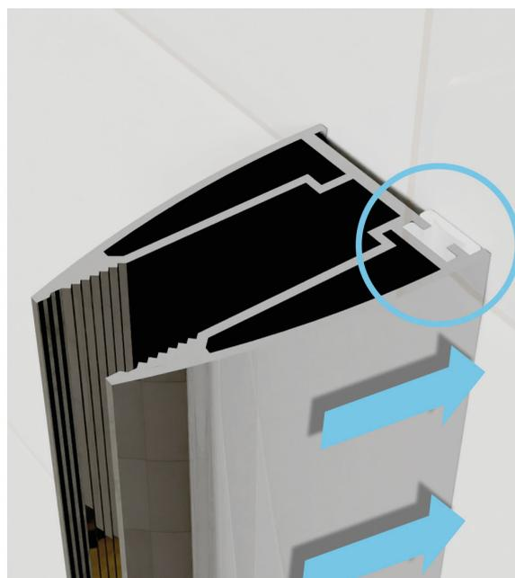
Le vissage du profilé au mur, entraîne l'écrasement du joint caoutchouc intégré, garantissant une étanchéité parfaite, sans ajout de pâte silicone.
